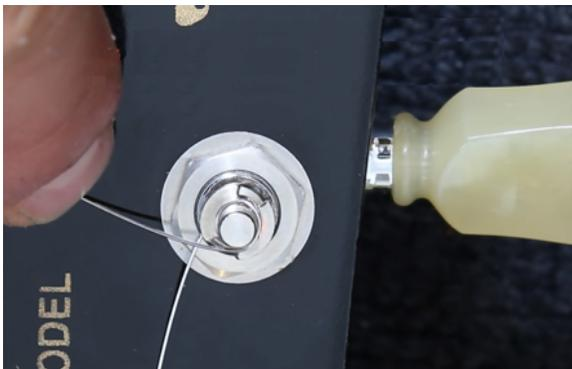
*Die Saiten in dieselbe Richtung wickeln (im Uhrzeigersinn) wie die Richtung zum Festziehen der Sicherungsmutter des Wirbels. Achten Sie darauf, dass Sie vor dem Festziehen der Sicherungsmutter die H- und hohe e-Saite zweimal herumwickeln.*
